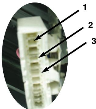
La résistance normale est d'environ  $3,0 \Omega$  entre deux broches (1, 2 ou 3) au connecteur du moteur.
