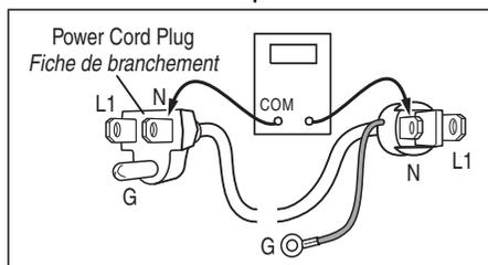
Power cord terminals, gas dryer. Cordon d'alimentation - sècheuse à gaz.
